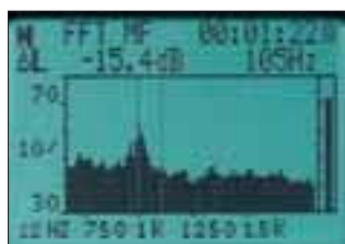
Analisi spettrale per banda fine (opzione FFT).
