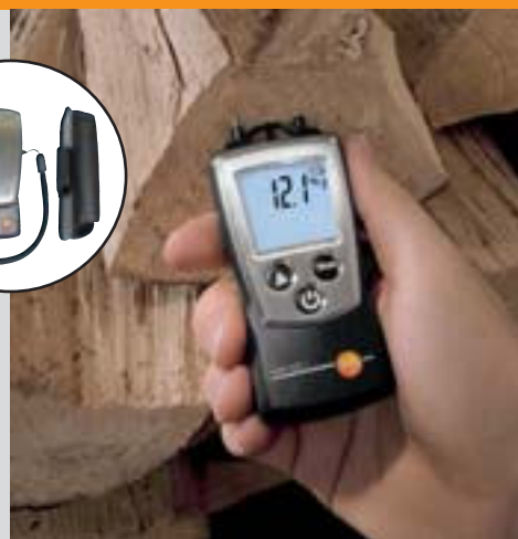
Controllo dell'umidità del legno
