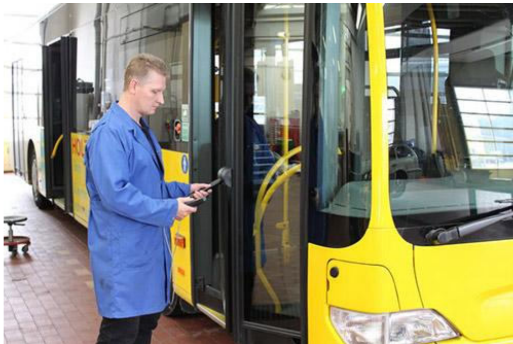
Il misuratore di forza di chiusura in uso.
